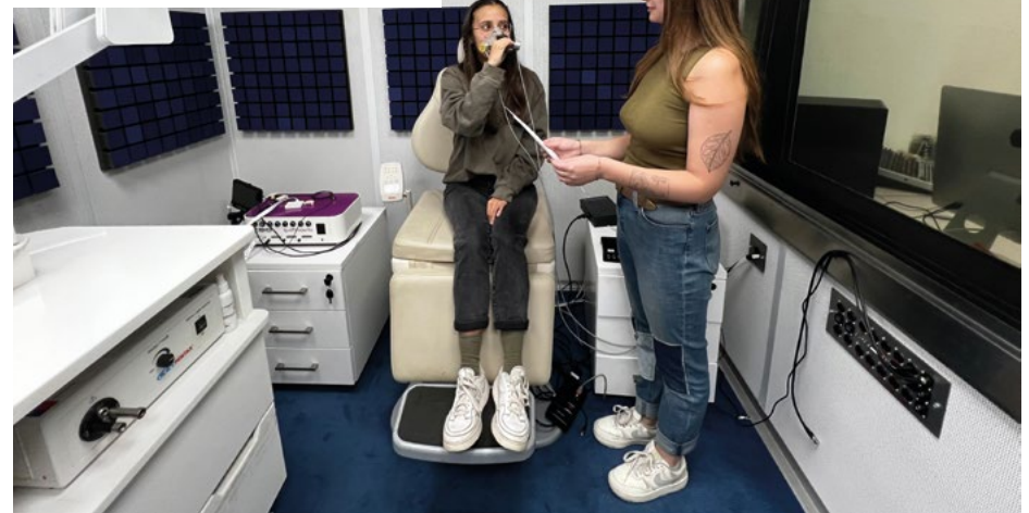
Registro de mediciones aerodinámicas de la voz en el laboratorio de tecnologías de la salud del Centro Avanzado de Ingeniería Eléctrica y Electrónica (AC3E), centro basal de excelencia de la Universidad Técnica Federico Santa María (USM)
